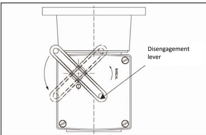
Fig. 7. Disengagement clutch
